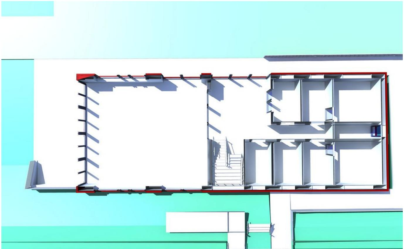
Grundriss Untergeschoss vom Preussendamm aus betrachtet, links der Multifunktionsraum, rechts Umkleide und Technik, links die barrierefreie Erschließung zum EG, rechts zum Sportplatz
